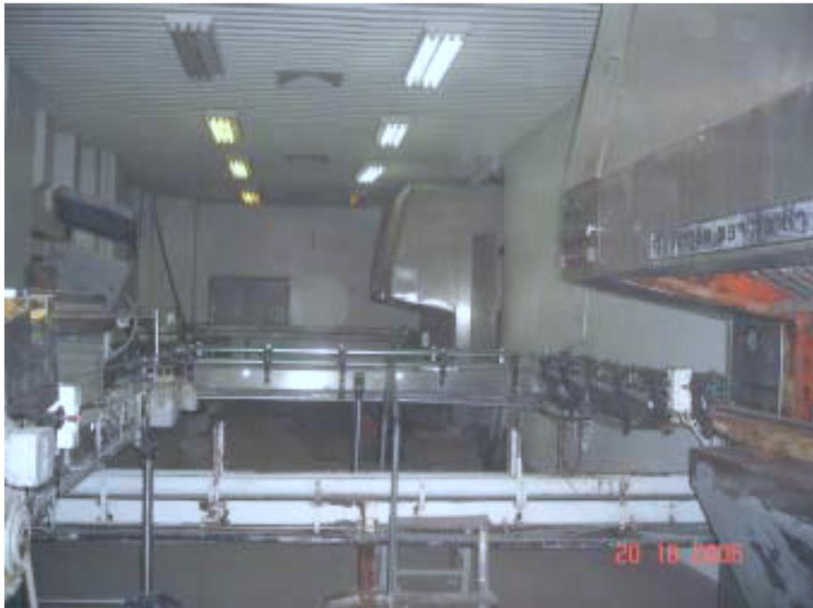
Foto 3 – Detalhe das saídas das máquinas de lavar garrafas de vidro
