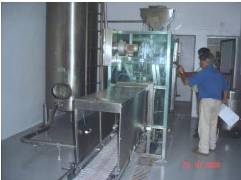
Foto 8 – Linha de envase de garrafão de 20 litros, com o túnel de raios ultravioleta, a envasadora automática blindada e o tanque pulmão em inox.
